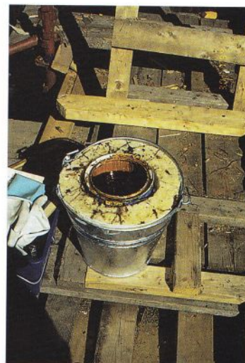
For at tjæren skal holde seg varm, er tjærespennet satt ned i en bøtte isolert med polyuretanskum.
